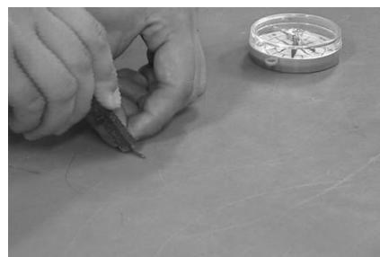
図 2 くぎを棒磁石でこすってくぎ磁石を作る
