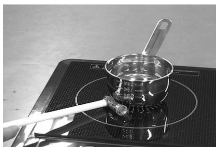
図 5 ストロー豆球で誘導電流を調べる
