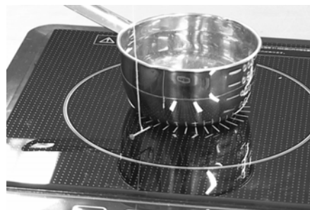
図 3 くぎ磁石で表面の磁界を調べる
