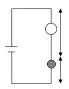
大きい抵抗のほうが大きな落差(電圧)で落ちる(電流が流れる)
