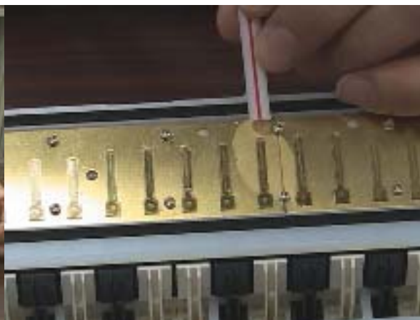
鍵盤ハーモニカの中のリードをストローで吹いて音を出す実験
