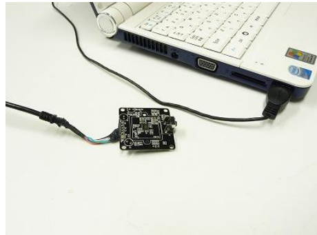
図10 パソコンへ接続したWebカメラ
